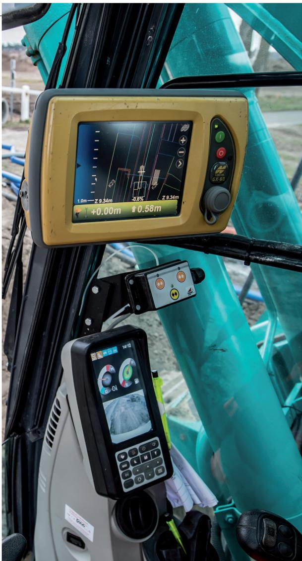
Les écrans ont fleuri dans les cabines, permettant aux conducteurs de positionner finement l'engin et ses équipements, et ainsi gagner en productivité et en sécurité.
